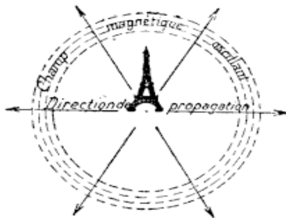
Fig. 275. — Orientation du champ magnétique oscillant d'une onde hertzienne par rapport à la direction de propagation.
