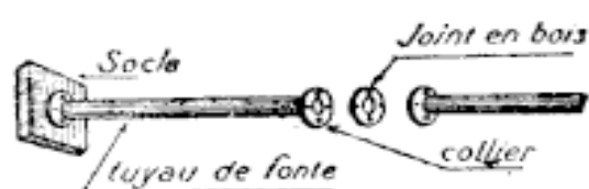
Fig. 19. — Détails du mât de l'antenne en parapluie.
