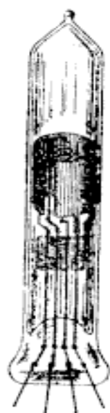
Fig. 76.— Tube à vide terminé.
