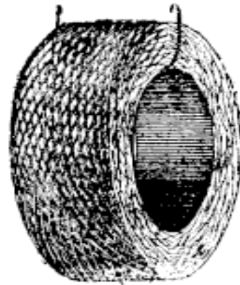
Fig. 150. — Enroulement « nids d'abeilles ».
