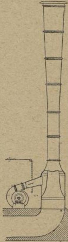
Fig. 225. — Tirage par ventilateur, système Prat. L'air refoulé par le ventilateur s'échappe par une ouverture annulaire en entraînant au centre les gaz de la combustion.
