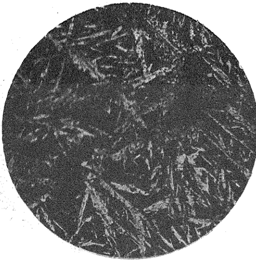
Fig. 74. — Martensite dans acier trempé.
