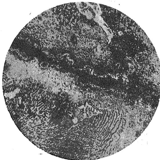
Fig. 66. — Fonte grise de Denain ; recuit partiel. G = 650 D .
