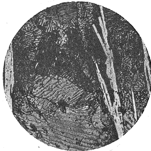
Fig. 71. — Acier de Firminy à 1,4 0/0 de carbone. Attaqué par HCl + Cu Cl 2 . — G = 650
