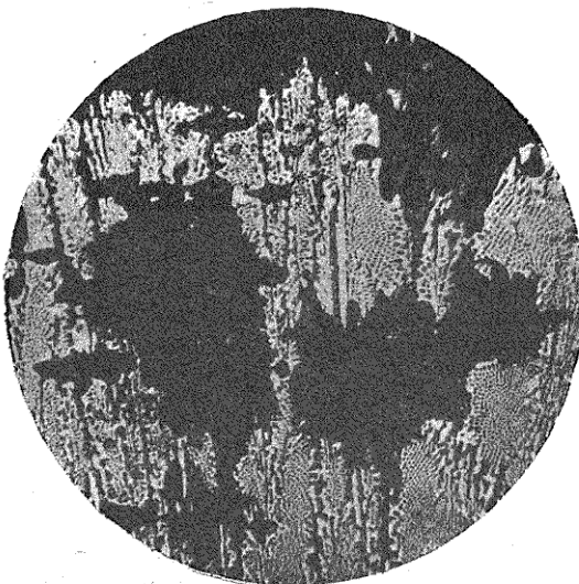
Fig. 68. — Fonte sursaturée en carbone; trempe et recuit au bleu. G = 125 .
