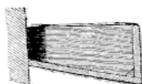
Fig. 38. — Auge en bois à bord vertical et à fond incliné vers l'avant.
