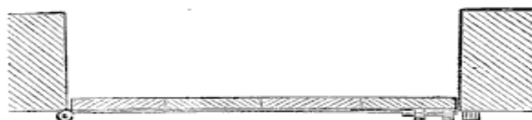
FIG. 87. — Plan de la porte de cour, représentée en élévation par la fig. 86. Échelle de 5 centimètres par mètre.
