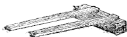
FIG. 50. — Disposition des chevrons sur la panne faîtière.
