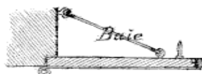
FIG. 82. Crochet retenant le dessus de la porte des loges de la porcherie de M. Allier.
