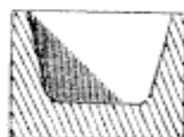
FIG. 21 bis. — Coupe transversale d'une auge de pierre taillée.
