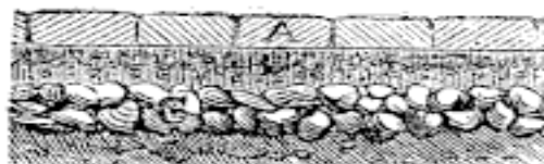
FIG. 17. — Coupe d'une aire de briques.
