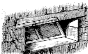
FIG. 68. — Fenêtre à châssis rotatif pour porcherie.
