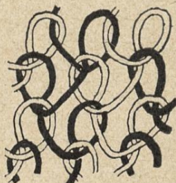
Fig. 58. — Disposition des fils dans un article-chaîne.
