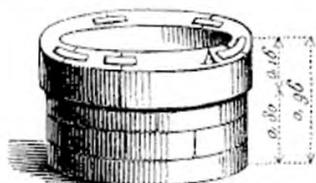
Fig. 61. Incrustation des crampons dans la pierre.
