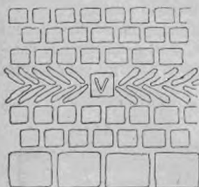
Fig. 128. Appareil en arête de poisson. Fig. 129. Appareil recticulé.
