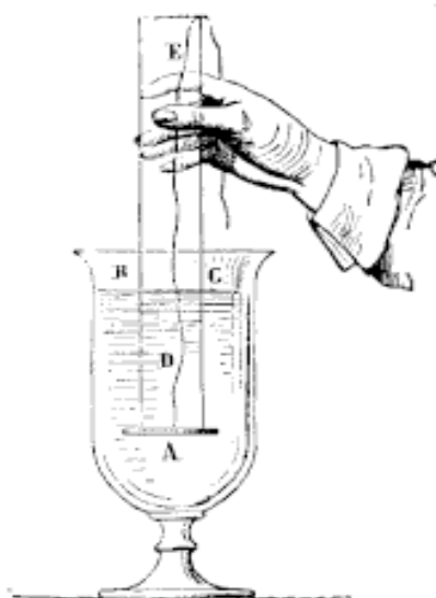
FIG. 107. — La poussée des liquides.
