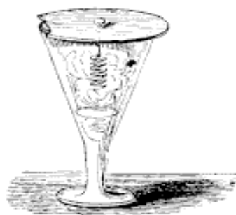
FIG. 106. — Incandescence du platine dans la vapeur d'alcool.
