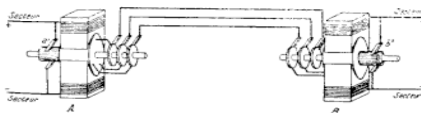
Fig. 50. — Commutatrices actionnées par courant continu et reliées par leurs bagues pour tourner synchroniquement.
