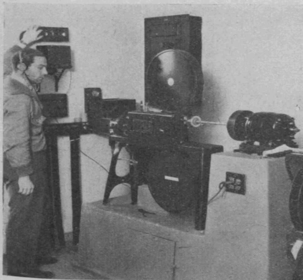
Fig. 55. — Vue d'ensemble de l'appareil d'enregistrement sonore sur films à valve de lumière système « Western » en cours de fonctionnement.
