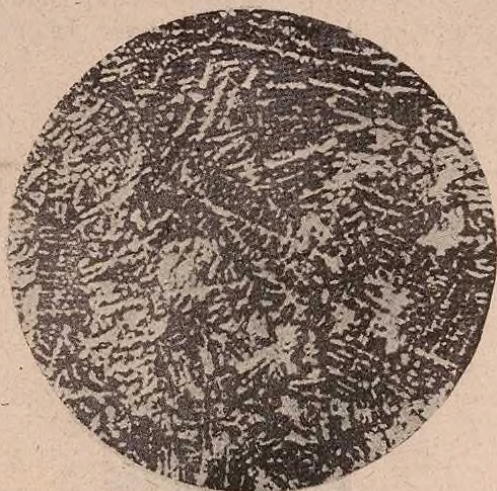
Aluminium coulé en coquille. Grossissement 40 diamètres.
