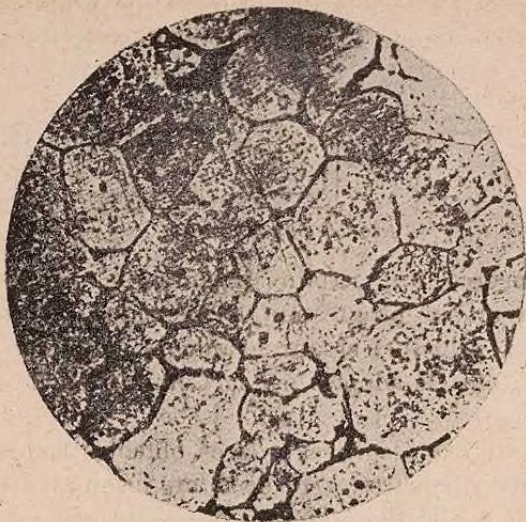
Aluminium recuit après écrouissage. Grossissement 100 diamètres.
