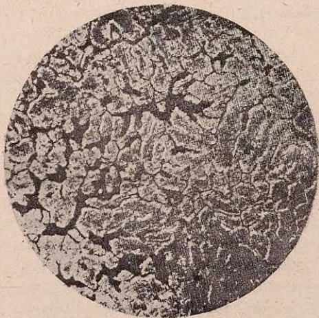
Aluminium coulé en sable. Grossissement 40 diamètres.
