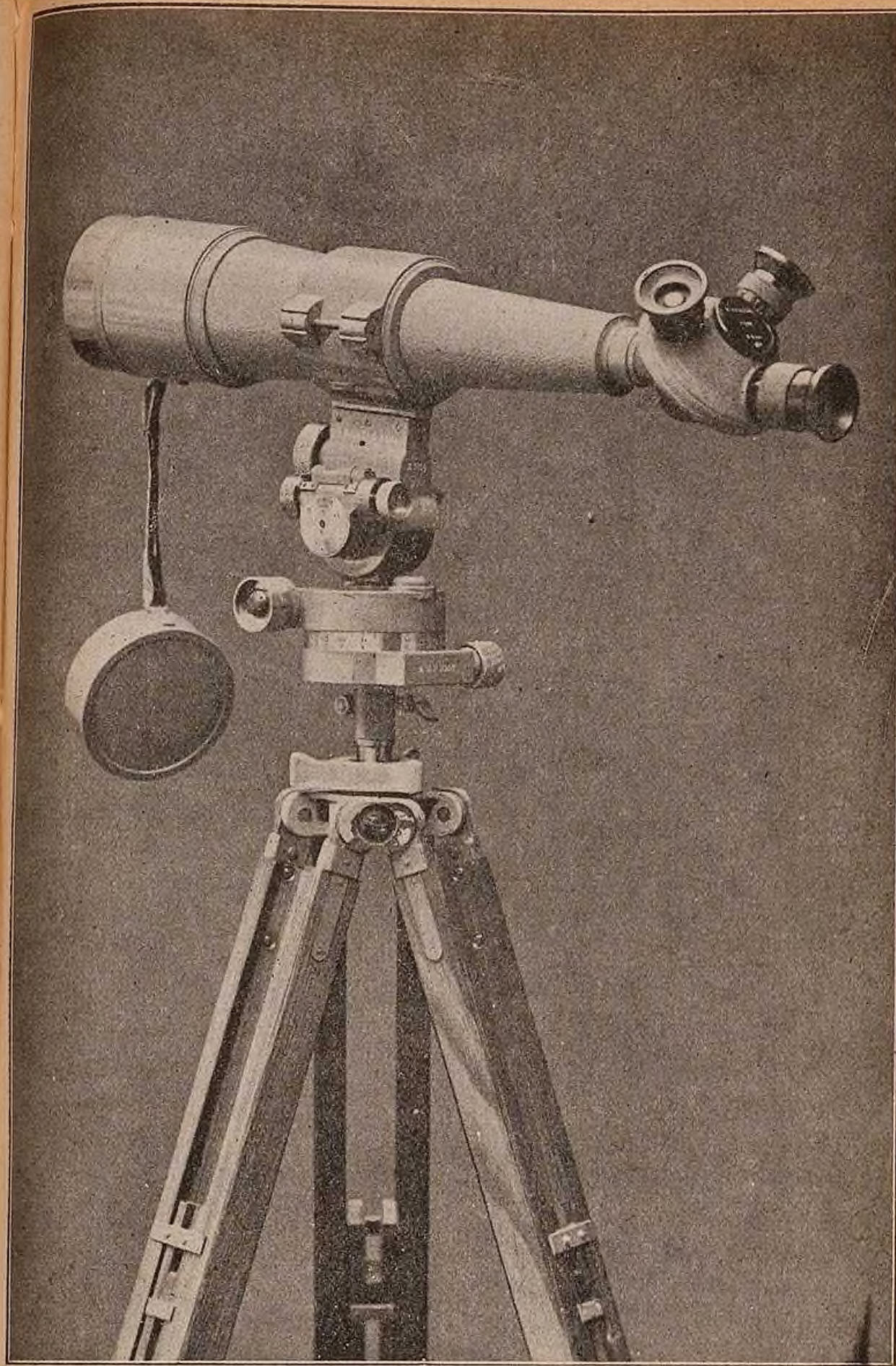
FIG. 12. — LUNETTE MONOCULAIRE A TROIS GROSSISSEMENTS
