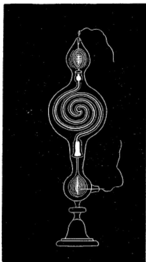
FIG 4. — Tube de Geissler.
