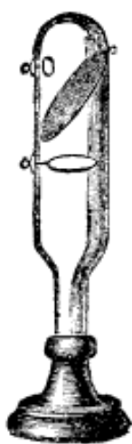
FIG. 11. — Action mécanique de la matière radiante.
