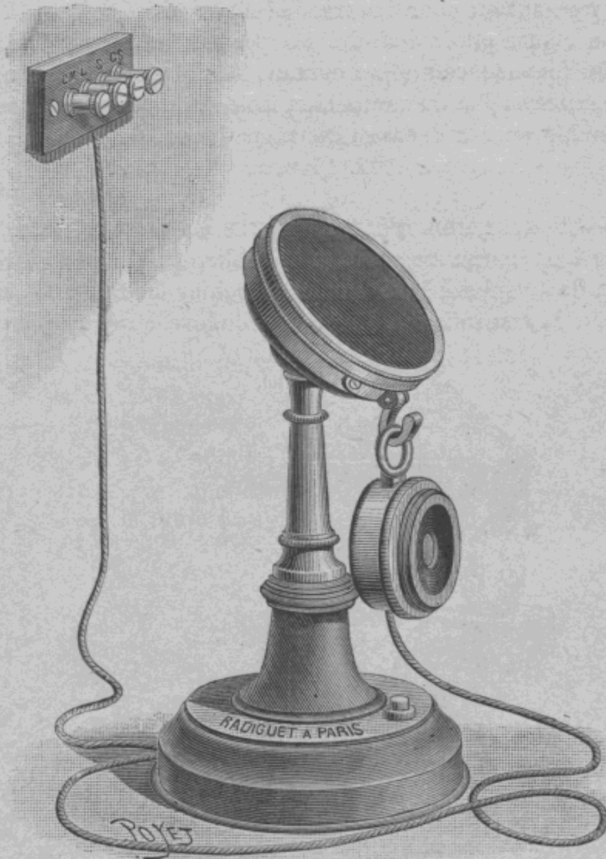
Fig. 66. — Poste à colonne de Radiguet
