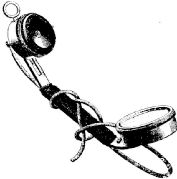
Fig. 75. — Modèle de poste microtéléphonique transmetteur et récepteur des bureaux centraux de téléphones
