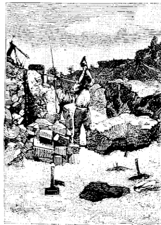
FIG. 666. — Carrière des Maréchaux. — Maître Carrier au travail. (Fente d'un bloc au moyen du couperet de 23 kilos.)
