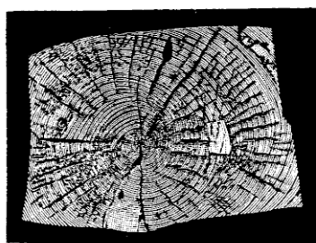
FIG. 436. — Section faite dans une pièce de Chêne maigre, échelle de 1/8. (Une grande fente a voilé la face supérieure et les deux latérales. A gauche, à mi-hauteur, une frotture formant tache blanche. En bas, au milieu, un trou de ver se détache en noir.
