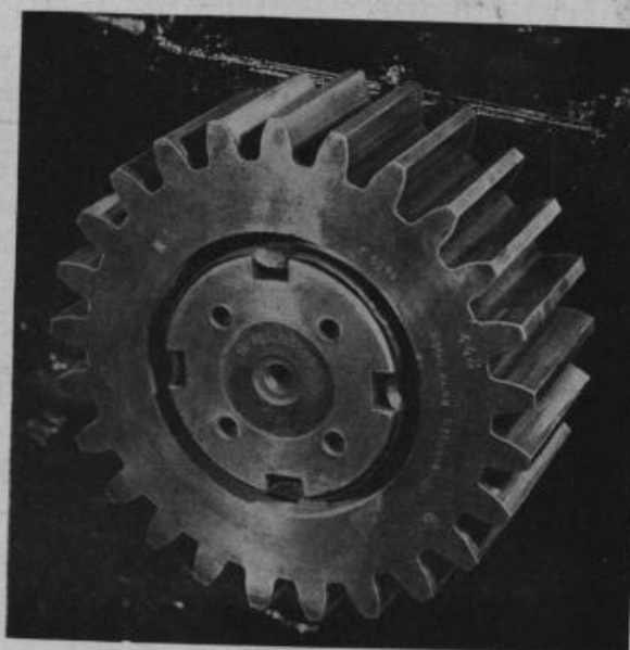
Fig. 31. — Etat de la denture d'un pignon de moteur au moment de la revision générale.
