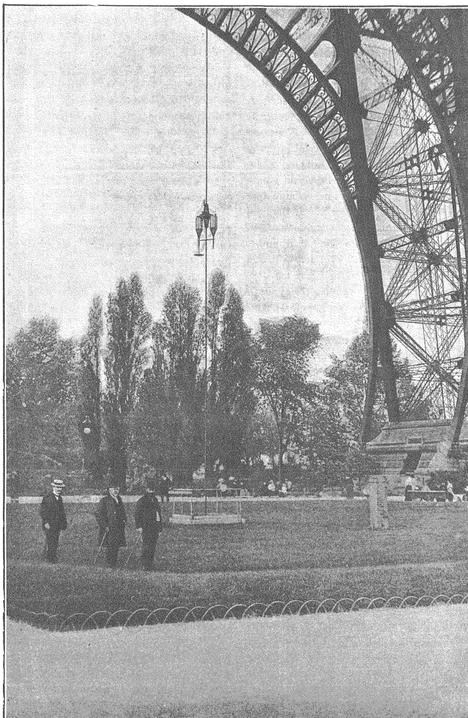
Fig. 400. — Disposition, à la tour de 300 mètres, de l'appareil de M. G. Eiffel pour mesurer la résistance de l'air.
