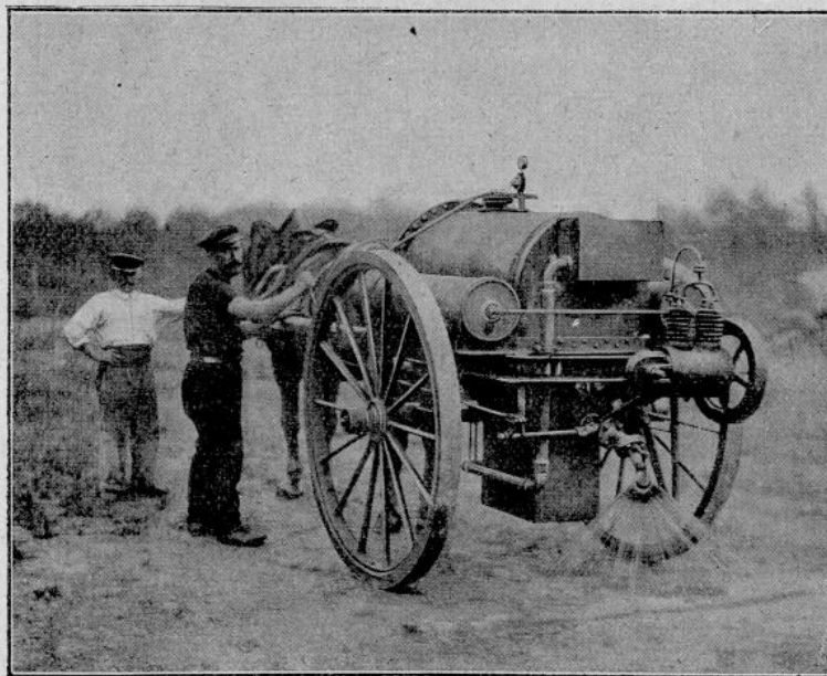
Fig. 4. — Appareil Vinsonneau et Hédeline, sans balai, pour le goudronnage mécanique superficiel des routes.
