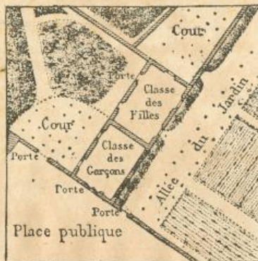
Fig. 3. — Plan de la maison d'école. (Longueur de la classe des garçons sur ce plan : 1 centimètre 1/2. — Le plan est à l'échelle de 1/600 e ).
