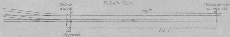
Fig. 2. Plan de pose de l'appareil en avant d'une bifurcation Echelle 1/1000
