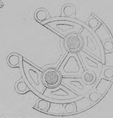
Fig. 10. Plan du piston glissière 1/20
