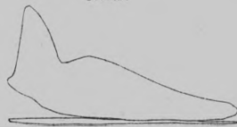
Fig 5. Diagramme du moteur à pétrole Roots
