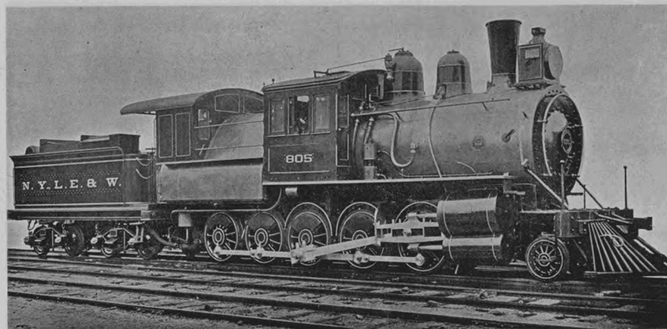
FIG. 1. — LOCOMOTIVE COMPOUND, 12 ROUES, TYPE « DECAPOD » DU « NEW-YORK, LAKE ERIC AND WESTERN RAILROAD »
