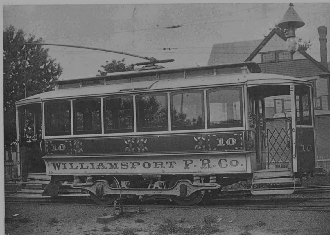
FIG. 2. — VOITURE A PLATES-FORMES FERMÉES EN PARTIE, MUNIE DE DEUX MOTEURS DE 25 CHEVAUX
