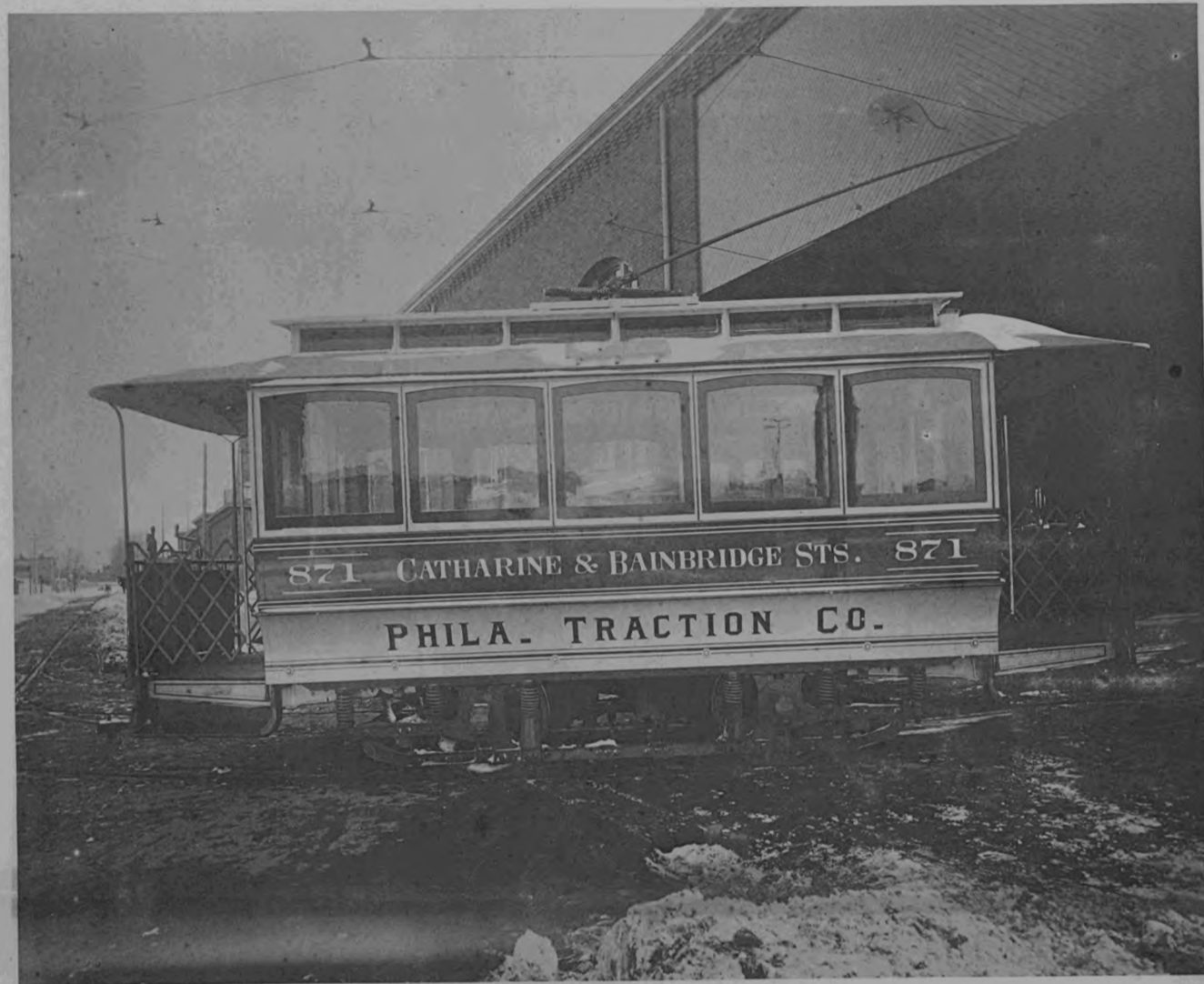
FIG. 1. — VOITURE ÉLECTRIQUE MUNIE DE DEUX MOTEURS DE 25 CHEVAUX WESTINGHOUSE
