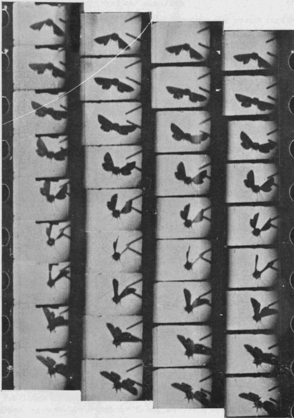
Fig. 16. — Enregistrement du mouvement vibratoire d'un diapason (48 vib./sec.) et du vol libre d'un Papillon (*Plusia gamma* L.). (2.488 vues par seconde)
