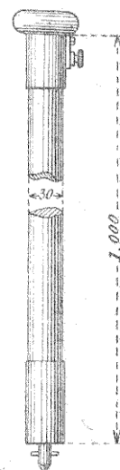
Fig. 800. — Baguette de contact de l'appareil de mesure de la conductance des joints.
