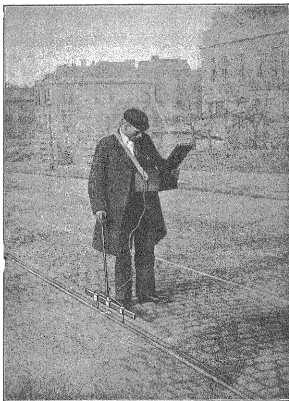
Fig. 796. — Appareil portatif de Lord Kelvin pour la vérification des connexions.
