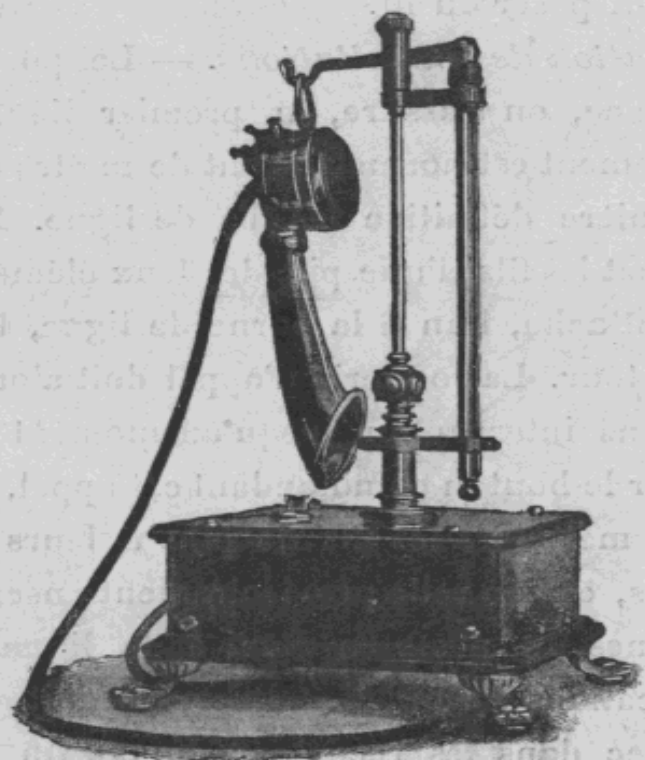
Fig. 96. — Poste téléphonique monophone, modèle de la Société Industrielle des Téléphones.
