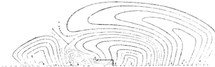
FIG. 140. — Ondes émises par une antenne horizontale sur la terre (K. Uller) montrant la grande radiation du côté convexe due aux pertes moins grandes d'énergie par résistance de la terre.
