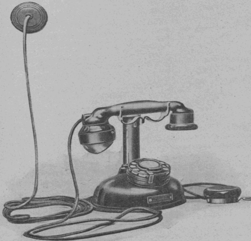
Fig. 167. — Poste mobile à B. C. avec combiné à récepteur électromagnétique et circuit et antilocal (muni d'un disque d'appel automatique).
