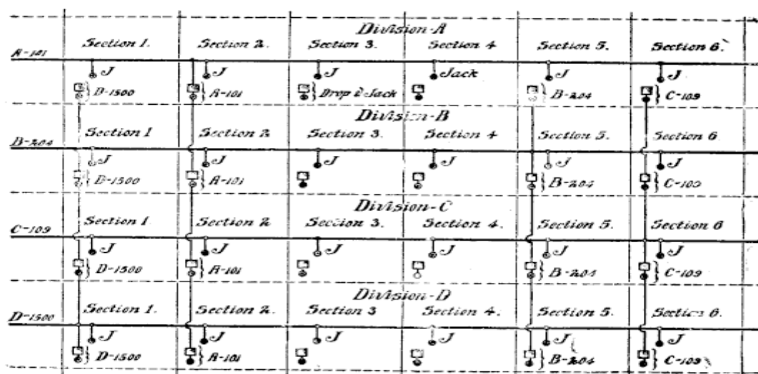
Fig. 82. — Disposition schématique d'un multiple divisé à 4 positions.
