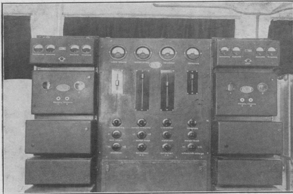
Fig. 6. Amplificateur "Kinoton", fonctionnant avec les machines de la vue précédente. L'ensemble est entièrement renfermé dans des carters métalliques. Tous les appareils de mesure se trouvent réunis de manière à pouvoir être observés d'un seul coup d'œil par l'opérateur.
