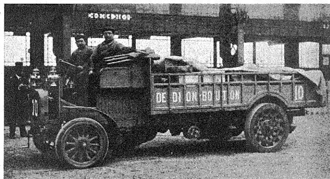
FIG. 137. — Concours de 1908. Camion lourd avec roues ferrées à l'arrière (charge utile : environ 4 tonnes).
