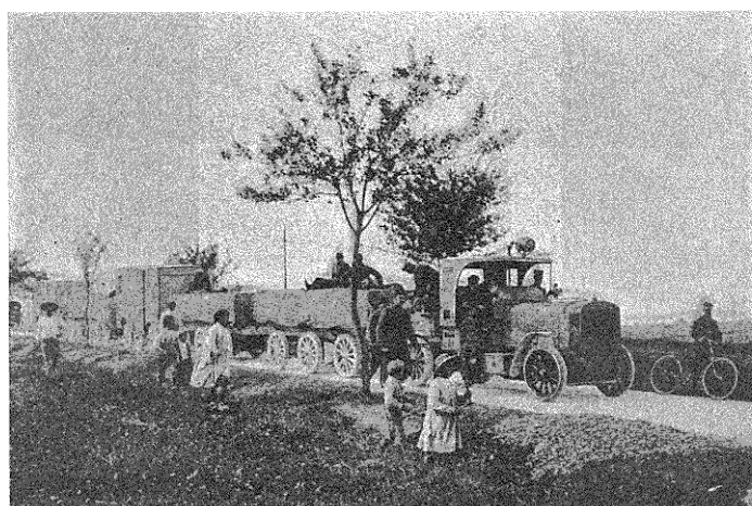
FIG. 11. — Manœuvres du VIII e corps (1907). Train Renard à 6 véhicules (18 tonnes de charge utile). Locomoteur de 75 HP.
