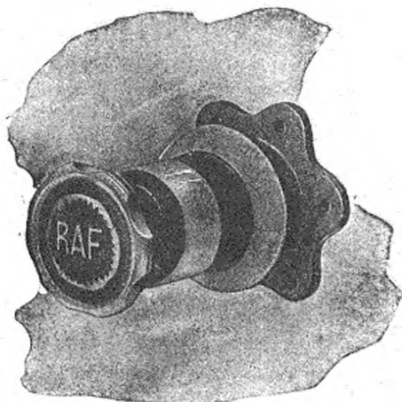
FIG. 137. — Un faux moyeu R.A.F formant cache-poussière.
