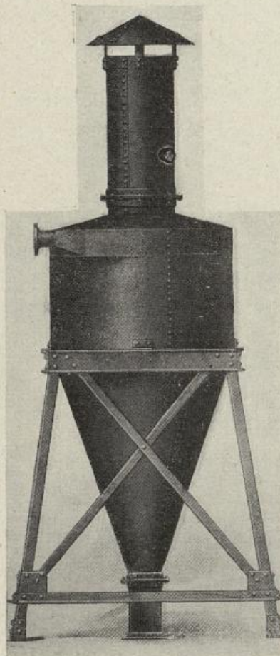
FIG. 42. — Séparateur cyclone, pour charbon pulvérisé, de la Société Quigley-France.
