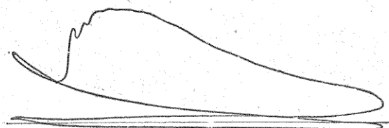
Fig. 18. — Avance à l'allumage trop faible. (La denture des courbes est due aux oscillations propres de la membrane du manographe.)
