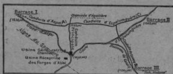
FIG. 935. — Schéma des installations hydroélectriques de Somport.
