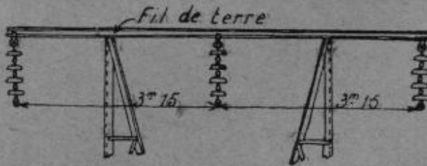
FIG. 987. — Usine de Boulder. — Ligne aérienne avec fil de terre.
