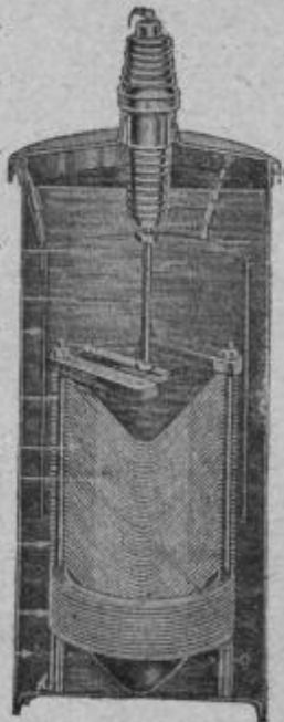
FIG. 1572. — Vue en coupe d'un parafoudre électrolytique. (Système Thomson-Houston)
