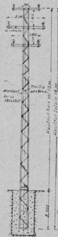
FIG. 1374. — Support métallique avec fers à U (Ligne Tencin-Brignoud).
