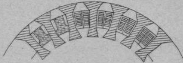
FIG. 1637. — Principe de construction des rotors à enroulements gabariés de l'A. E. G.
