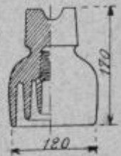
FIG. 1514. — Isolateurs des lignes du Littoral de la Méditerranée.
