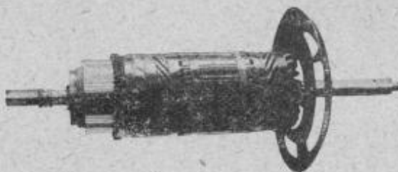
FIG. 1028. — Induit de dynamo avec ventilateur. (C on Bréguet).
