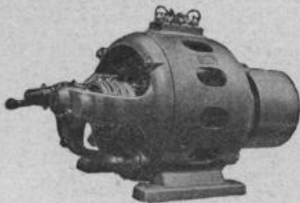
FIG. 1186. — Moteur triphasé à induit bobiné (Société l'Éclairage Électrique).
