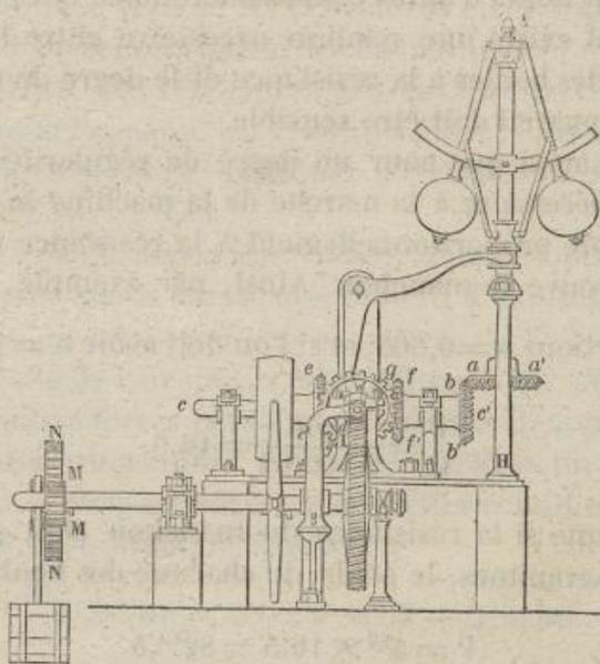
doux deux roues, dentées à engrenages coniques  $ee'$  et  $ff'$ , munies d'un embrayage à griffes qui peut engrener avec un manchon  $dd'$  mobile sur l'arbre  $cc'$  dans le sens de sa longueur. Il résulte de cette disposition que ces deux roues  $ee'$  et  $ff'$  ne participent au mouvement de rotation de l'arbre  $cc'$  que quand elles sont embrayées avec le manchon  $dd'$ .
