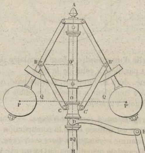
manchon se maintiennent à la même position, parce qu'il s'établit un état d'équilibre entre la force centrifuge et le poids des diverses pièces de l'appareil. Quand la vitesse augmente, il en est de même de la force centrifuge, qui tend à écarter davantage les boules et à relever le manchon, et par suite l'extrémité du levier DE. A l'inverse, si la vitesse diminue, les boules se rapprochent de l'axe, le manchon et l'extrémité D du levier DE s'abaissent.
