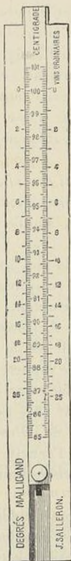
Fig. 92. — Ebuliomètre de Salleron. Fig. 93. — Echelle ébulliométrique.
