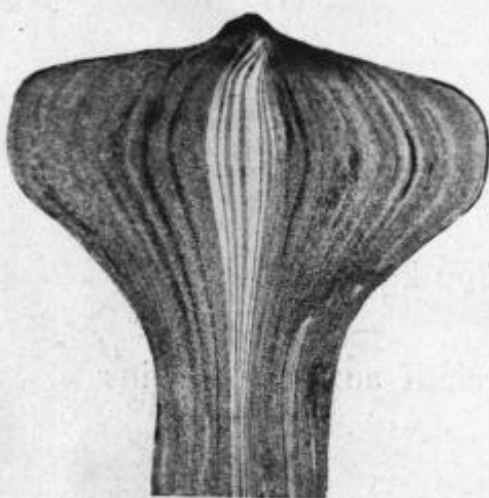
Fig. 24. Première phase de forgeage d'une soupape.
