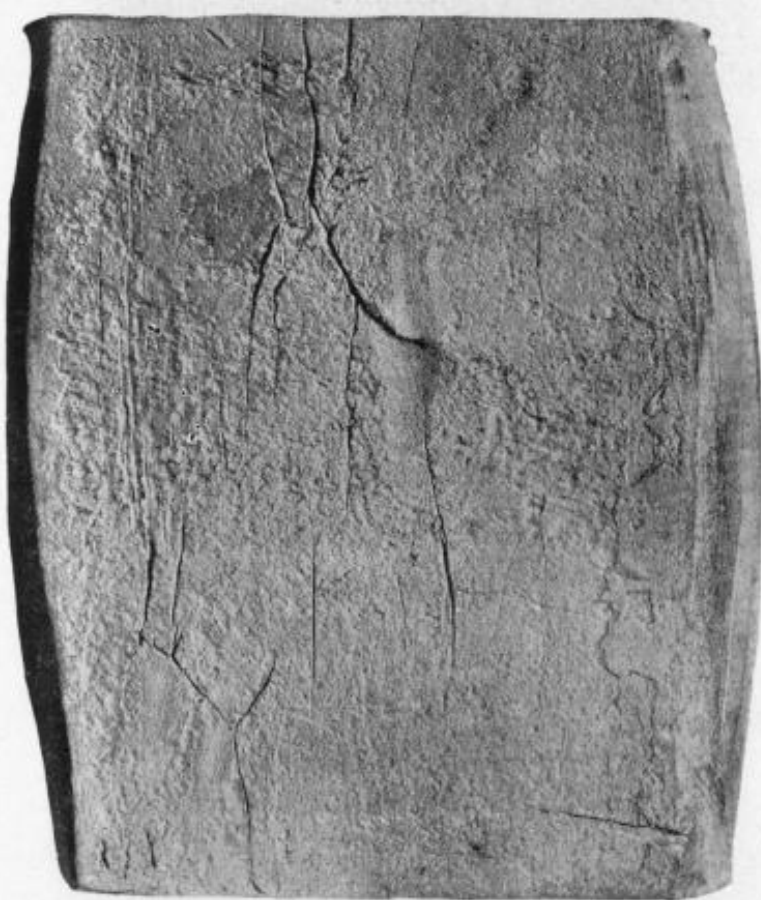
1. — Défauts d'un lopin (pailles et lignes) mis en évidence par aplatissement préalable à la forge.
