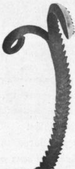
Fig. 17. — Copeau fourchu résultant du burinage d'une ligne qui le divise sur une partie de sa longueur.
