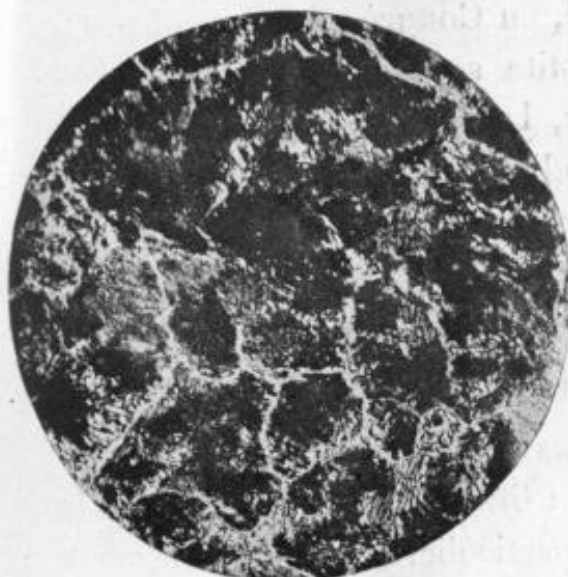
Acier hypereutectoïde. Attaque à l'acide picrique.
