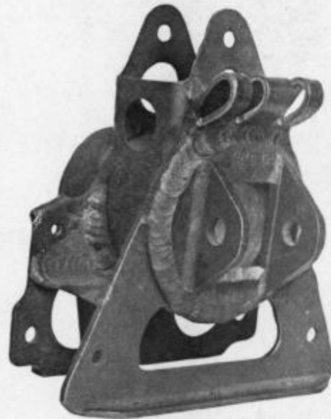
Fig. 27. — Pièce fabriquée par assemblage de tôles soudées et montrant les amas de soudure.
