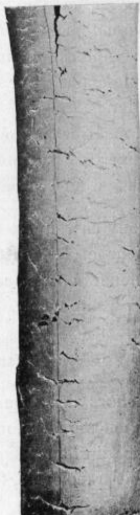
3. — Hauban fuselé dont les criques de laminage (métal rouverain) se sont ouvertes lors de l'aplatissement par laminage à froid.
