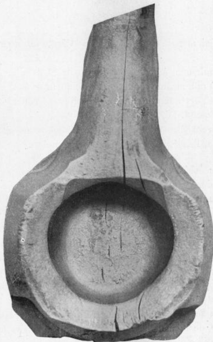
1. — Tête de bielle brute de forge présentant des lignes ouvertes par le forgeage.
