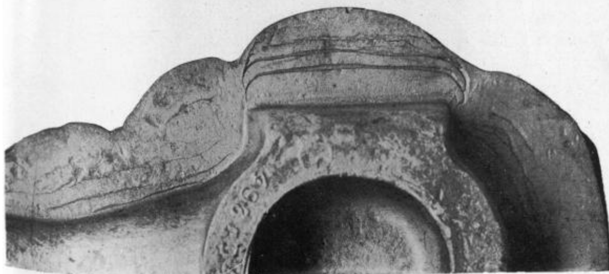
2. — Demi-tête de bielle montrant sur la bavure l'écoulement du métal par vagues successives à chaque coup de mouton.
