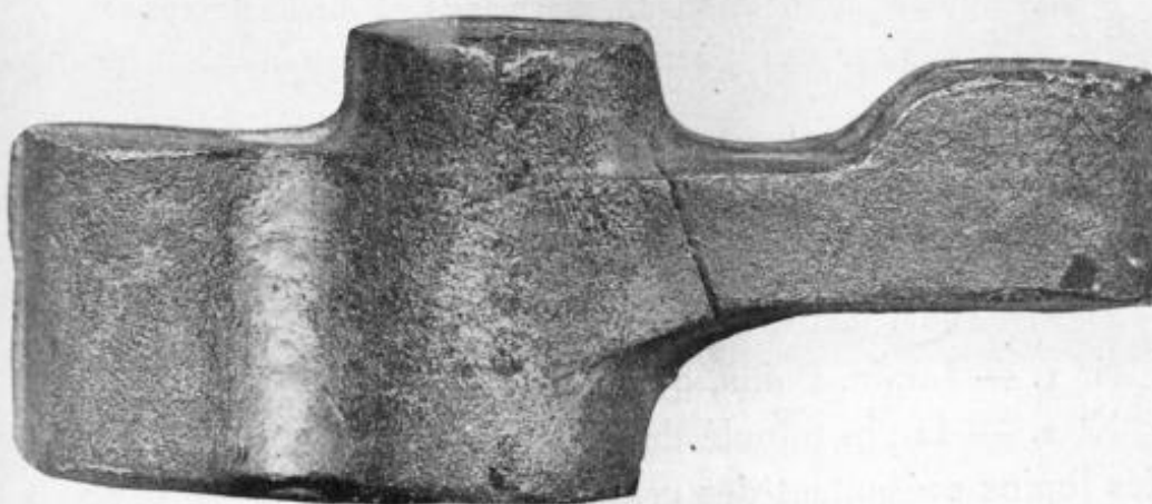
2. — Culbuteur présentant une repliure ou reprise au matriçage par suite d'une mauvaise conception de l'ébauche de forge.
