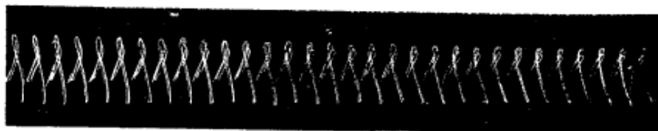
Fig. 79. — Graphique d'une verge de Wheatstone accordée à l'octave, munie d'une aile de guêpe et orientée de manière à enregistrer surtout la boucle supérieure du 8.
