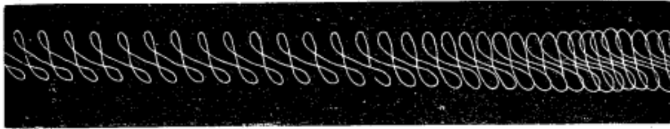
Fig. 76. — Graphique d'une verge de Wheatstone accordée à l'octave, c'est-à-dire vibrant deux fois transversalement pour chaque vibration longitudinale (figure empruntée à R. Kœnig). Le ralentissement du cylindre produit la condensation des courbes vers la fin du graphique.
