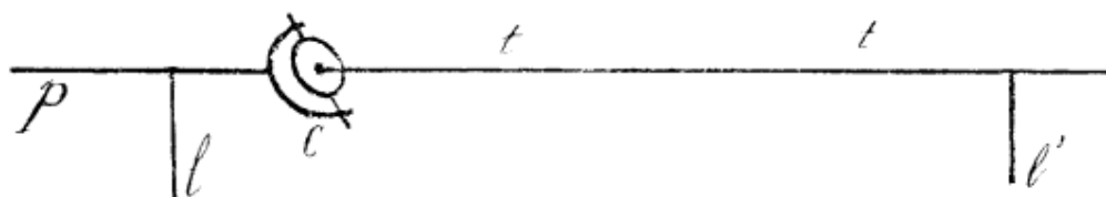
Fig. 58. — Représentation schématisée du levier pantographique transmettant les changements de position de l'aile et les changements d'inclinaison de sa surface.
