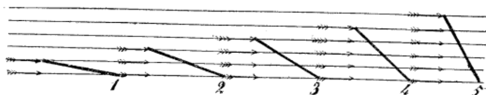
Fig. 122. — Figure théorique montrant que la résistance de l'air à un plan incliné est proportionnelle au sinus de l'angle que ce plan forme avec la direction du mouvement.
