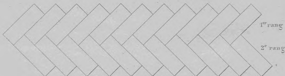
Fig. 9. Briques posées en épis pour carrelage.
