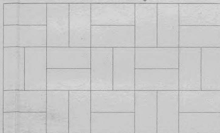
Fig. 14. Briques de M r Goullier arch te pour Cheminées encastrées dans les murs.
