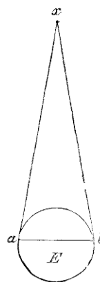
Fig. 80. — Distance des astres. — Méthode trigonométrique.
