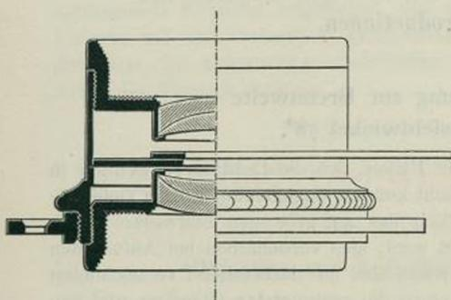
Unter Umständen, besonders für genannte Zwecke, ist es oft unvermeidlich, Aufnahmen von einer sehr kurzen Entfernung aus zu machen, und müssen hierzu Objective mit sehr grossem Bildwinkel angewendet werden. Diesen Zweck erfüllen die Weitwinkel-Euryscope, welche einen ausserordentlich grossen Bildwinkel umfassen, und daher Gegenstände, welche bei den
