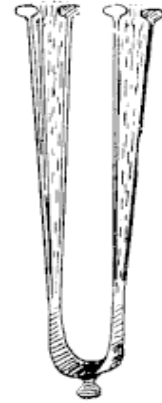
Fig. 1. — Aspect d'une paire de pincettes vibrant comme un diapason.
