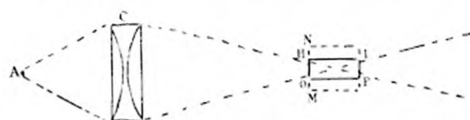
FIG. 122. — Schéma montrant la relation entre le diamètre de l'objectif et la luminosité.
