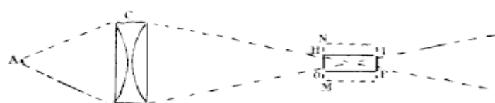
FIG. 122. — Schéma montrant la relation entre le diamètre de l'objectif et la luminosité.
