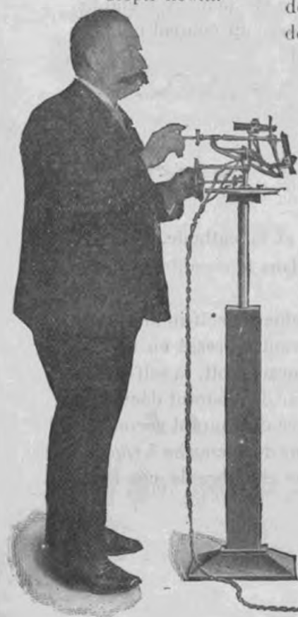
FIG. 88. — Convertisseur Cooper-Hewitt, modèle automatique.
