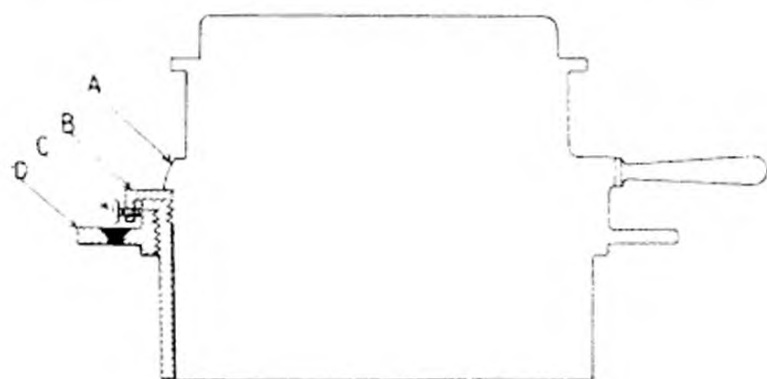
A, plaque avec index. — B, traits de repère des distances. — C, Vis de blocage. D, rondelle de fixation sur l'appareil.
