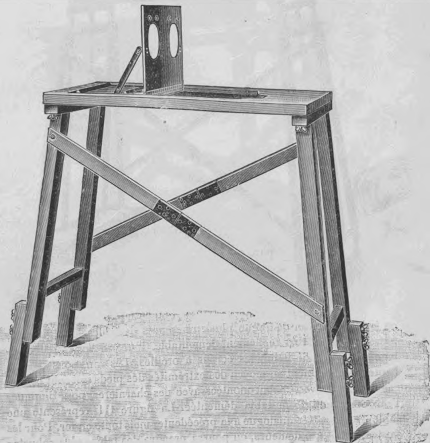
FIG. 110. — Table démontable en bois, modèle Pathé.
