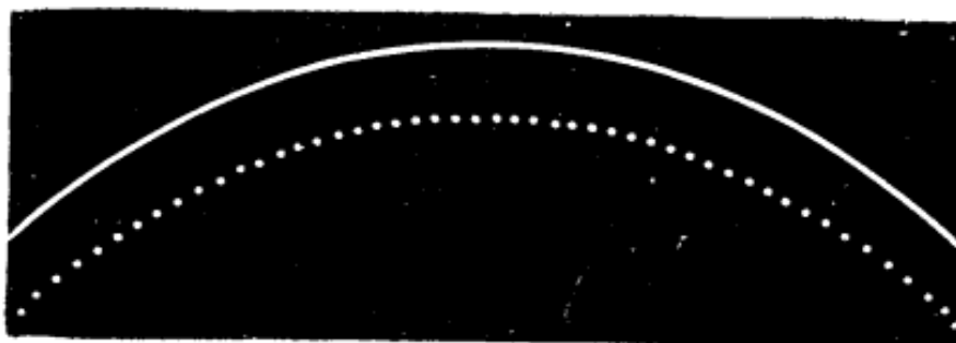
Fig. 37. — Trajectoire simple et trajectoire chronophotographique d'une boule brillante qui se déplace devant un champ obscur.
