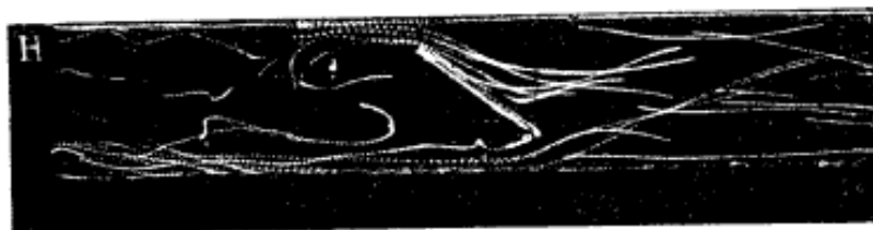
Fig. 68. — Changements de vitesse et de direction des molécules liquides dans un courant qui rencontre un plan incliné.
