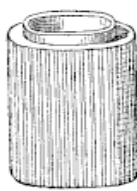
Fig. 11. — Tuyau en poterie pour conduite de fumée.
