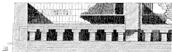
Fig. 2. — Coupe d'un hypocauste découvert à Paris (ancienne rue de Constantine). (Échelle de 0 m ,005 pour mètre.)
