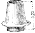
Fig. 23. — Mitron pour augmenter le tirage des cheminées.
