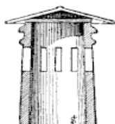
Fig. 211. — Couronnement d'une cheminée d'appel (1 er mode).
