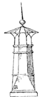
Fig. 212. — Couronnement d'une cheminée d'appel (2 e mode).
